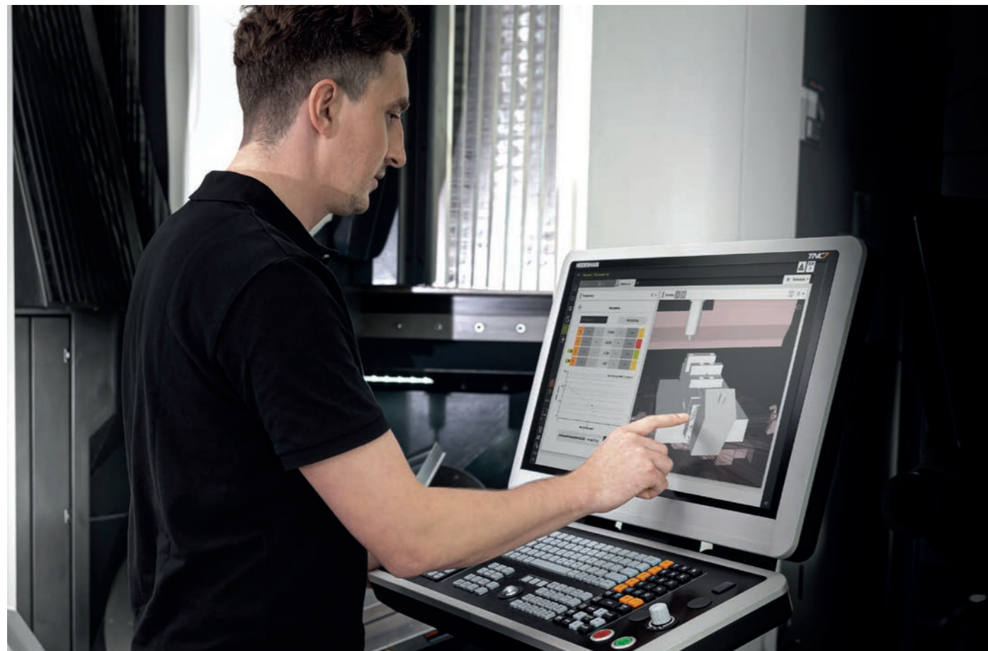
Funktion Spannmittel einrichten mit geöffnetem Arbeitsbereich Simulation
